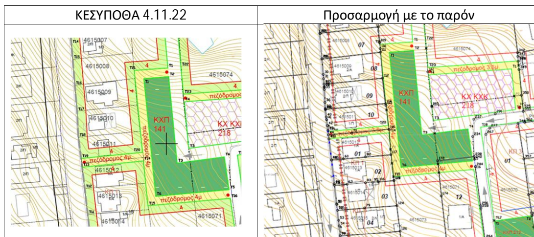
Εικ 1: Μείωση πλάτους πεζοδρόμου μεταξύ των ΟΤ 140 και 143 από 4μ. σε 3,5μ.
